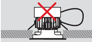
Afin de garantir une durée de vie optimale, le driver ne doit pas être en contact avec le luminaire.
