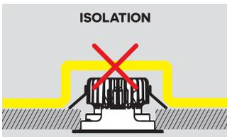
Le luminaire ne doit pas être recouvert d'isolation ou autre matière.
